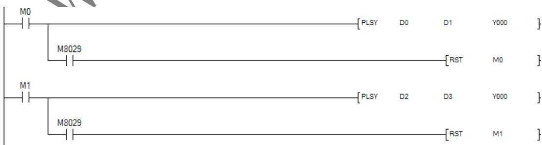
特别注意：如果第一条 PLSY 的驱动条件 M0 一直被置位，那么当第一条 PLSY 指令动作完成后，第二条 PLSY 依然不会动作，直到 M0 被复位。这在 CALL 或者 JP 指令中应特别注意，应避免在跳转中被驱动一次后不再执行断开动作的情况，这样会导致高速指令被锁定无法被继续使用，直到在 CALL 中再次断开动作。
