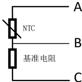
NTC 热敏电阻需要将随机赠送的基准电阻并联到 BC 脚之间，同时将热敏电阻并联到 AB 脚之间。
