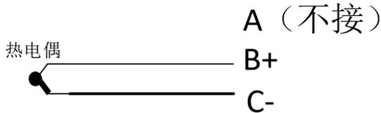
热电偶负极接 C 脚，正极接 B 脚，A 脚悬空不接任何信号。
