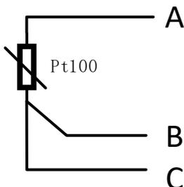
三线制 Pt100、Pt1000 或 Cu50 热电阻接线方法如上图，颜色相同的两个脚分别接到 B 脚与 C 脚上；如使用的是 2 线制热电阻则需要将 BC 两个端子短路。
